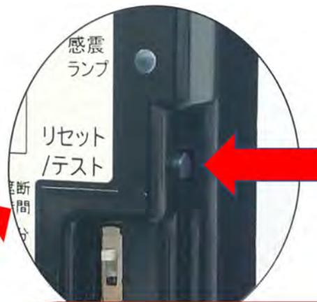
② リセット/テストボタンを5秒以上押し続けます。※感震ランプが点滅し、ブザーが鳴動しますが、そのまま押し続けてください。
